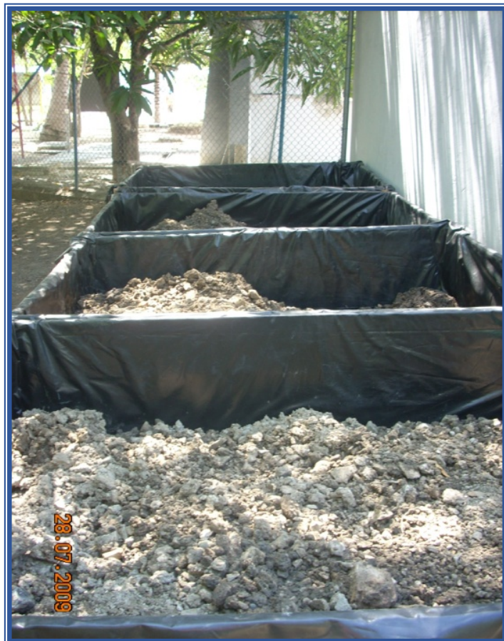
Figura 11 Microceldas de landfarming con tierra contaminada
