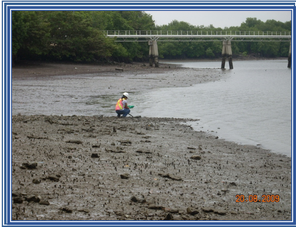
Figura 13. Toma de muestra del lecho marino en la Estación de Transferencia de Tres Bocas
