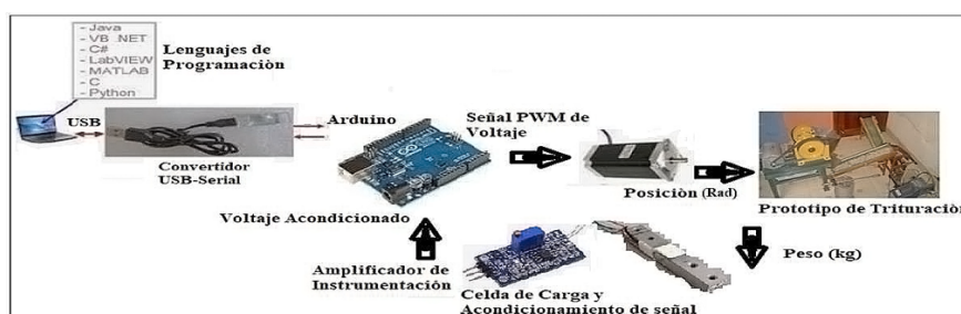
Figura 2.13 Diagrama funcional de la instrumentación utilizada en el proceso de trituración objeto de estudio, que incluye el motor PAP, Fuente: Autor
