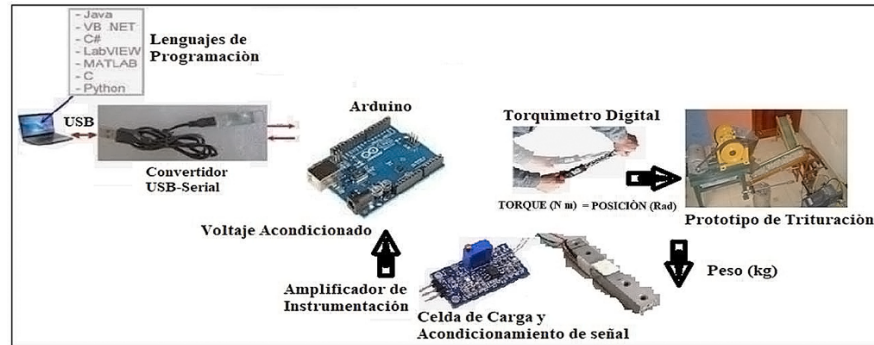
Figura 2.10 Diagrama funcional de la instrumentación utilizada en el proceso de trituración objeto de estudio, Fuente: Autor.
