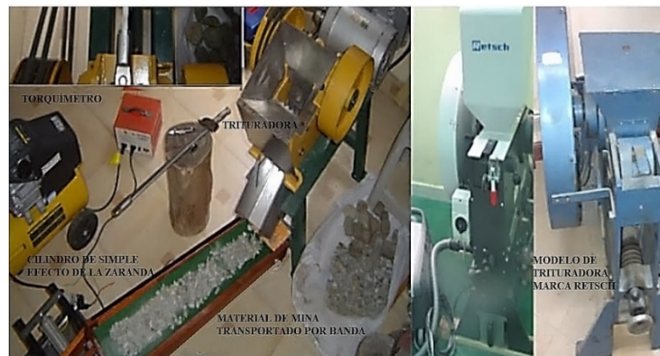
Figura 2.8 Fotografía del Prototipo de trituración desarrollado en la UNL a la izquierda y el que se tomó como modelo para su fabricación, desarrollado en Alemania y de marca Retsch, derecha, Fuente: (Benavides, 2014).
