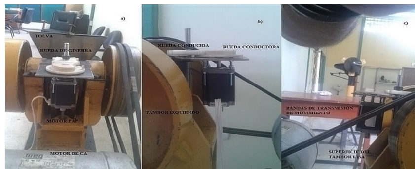
Figura 2.12 a) Montaje de la Rueda de Ginebra, b) Sistema de Rueda Conducida y Conducadora y c) Motor PAP y tambor derecho, finalmente se construyó y empleo para este trabajo la Rueda de Ginebra, Fuente: Autor.
